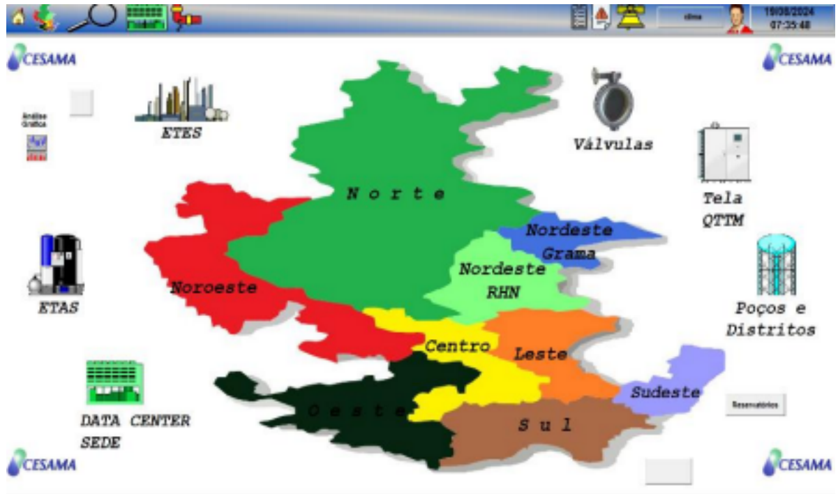
FIGURA 10 – Tela Principal do Sistema Supervisorio usado pela CESAMA (Elipse E3)
