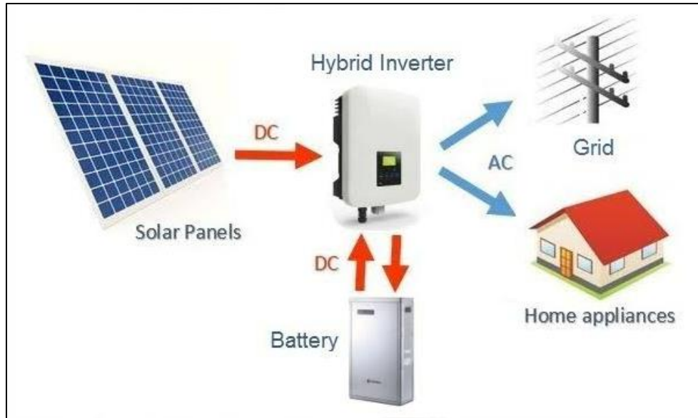
Figura 1 - Sistema de Backup de energia
