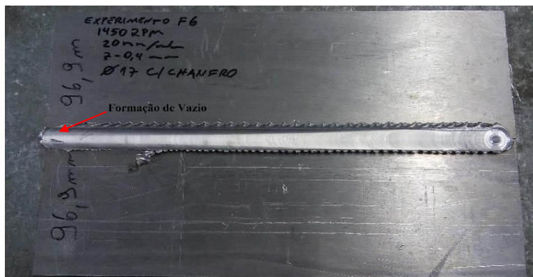
Figura 1. Aspecto superficial da junta soldada.
