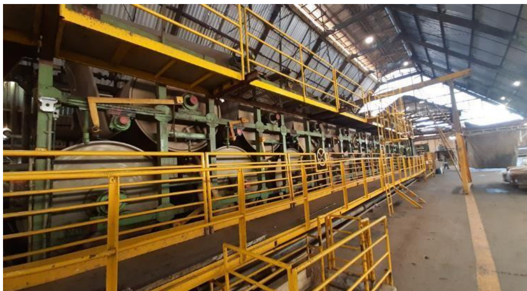
Figura 19 – Máquina de produção de Papel pardo, Ind. Papeis
