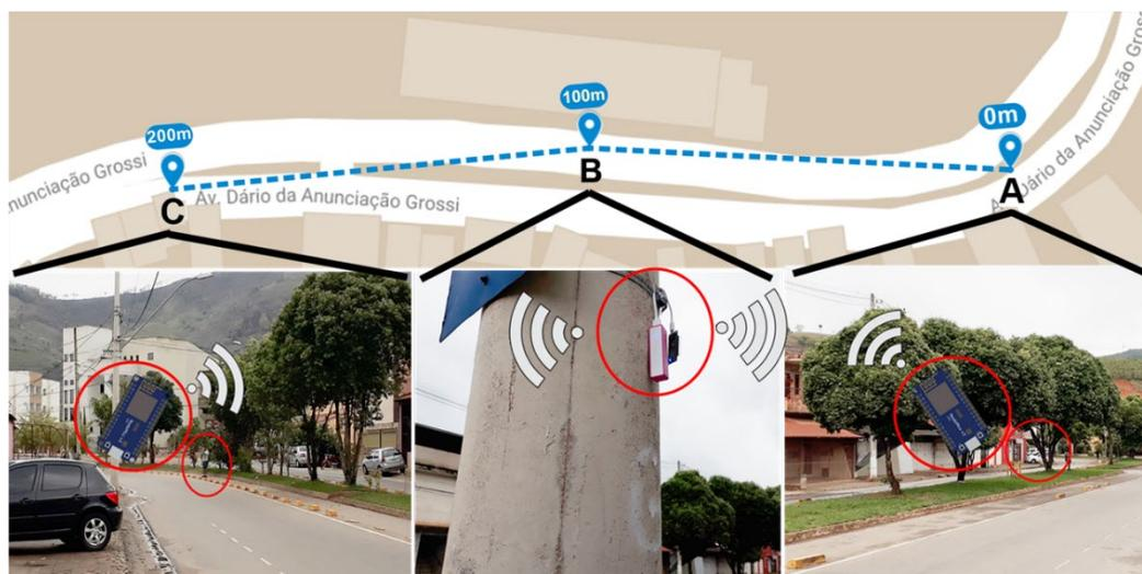
Figura 8 - Detalhes do experimento que verificou distância de comunicação entre os nós
