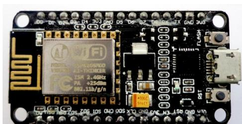
Figura 2 - Placa de desenvolvimento NodeMCU
